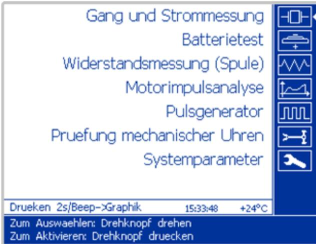
Die Bedienung ist einfach und leicht verständlich. Übliche Standardmessungen erfolgen weitgehend automatisiert, wobei die relevanten Parameter vom Gerät bestimmt werden. Der ambitionierte Benutzer kann die Messparameter nach seinen Bedürfnissen auch manuell wählen. Auf dem 1/4 VGA Grafikdisplay werden das Hauptmenü, Resultate, Parameter und Untermenüs angezeigt.
