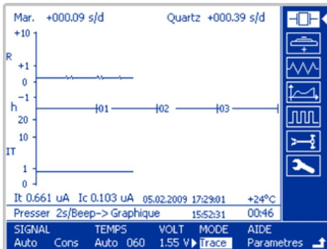
Enregistrement de longue durée sous forme de diagramme des mesures de la marche, du courant et du taux de hachage. L'enregistrement de longue durée permet de consigner les modifications de la déviation de la marche (par exemple sous l'influence de la température) et du taux de hachage des montres à impulsions adaptatives du moteur (par exemple lors du changement de date) pour une durée atteignant 60 heures.
