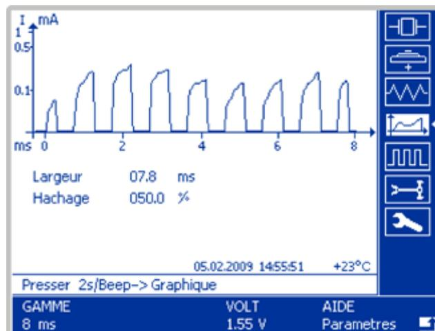
La forme des impulsions de courant est représentée par une courbe. La forme des impulsions représente un critère important du bon fonctionnement d'une montre. La largeur d'impulsion et le taux de hachage sont affichés numériquement. Par des mesures comparatives avec une bonne montre du même type on peut détecter des défauts de la partie mécanique de la montre.
