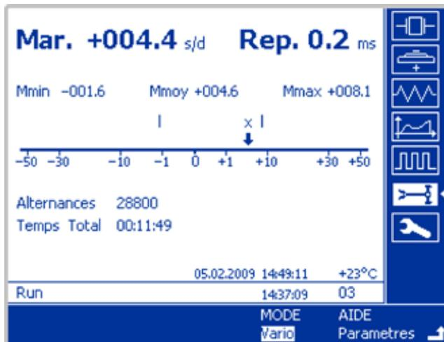
Le mode d'affichage VARIO permet d'effectuer des mesures simples et efficaces de la marche et l'interprétation de la qualité de marche de montres mécaniques. Les résultats sont présentés en forme graphique sur une échelle logarithmique.
