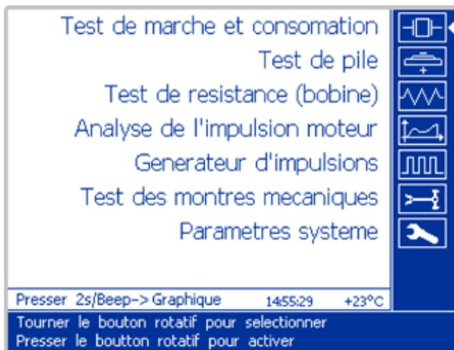
L'utilisation est simple et facile à maîtriser. Les mesures standard usuelles peuvent être automatisées en grande partie; l'appareil détermine les paramètres nécessaires. L'utilisateur plus avancé peut aussi choisir les paramètres de mesure en fonction de besoins particuliers. Les résultats, menus et paramètres apparaissent sur l'affichage graphique LCD ¼ VGA.
