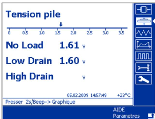
Les piles Low Drain sont testées automatiquement avec une résistance de charge adéquate. Les piles High Drain sont testées manuellement en pressant un bouton.
