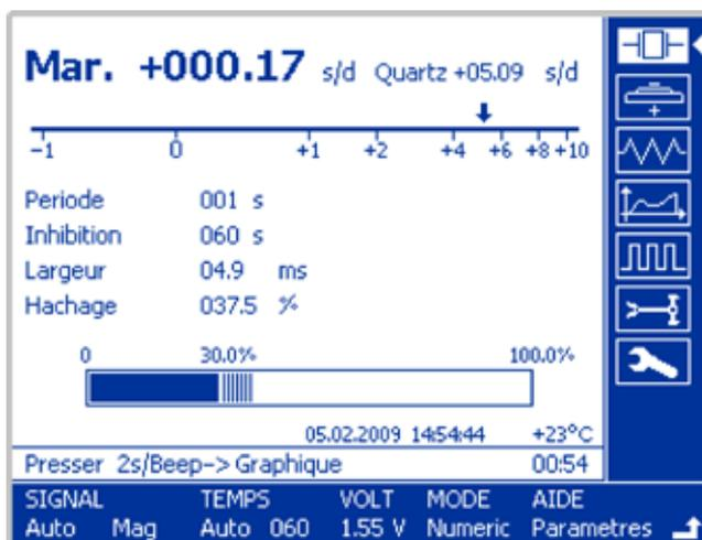
Outre l'affichage de la marche, l'analyse du signal magnétique permet de mesurer la durée de la période et la largeur des impulsions ainsi que la période d'inhibition et le taux de hachage. Ainsi on peut sans ouvrir la montre déterminer le rendement de l'entraînement.
