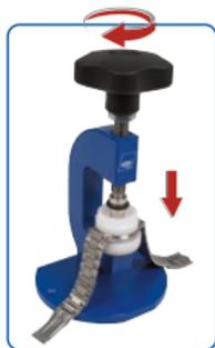
**Achtung:** Zu kleine oder zu große Druckstücke können den Gehäuseboden, das Glas usw. beschädigen. Bitte nutzen Sie auch die richtigen Druckstücke für gewölbte Gläser!
